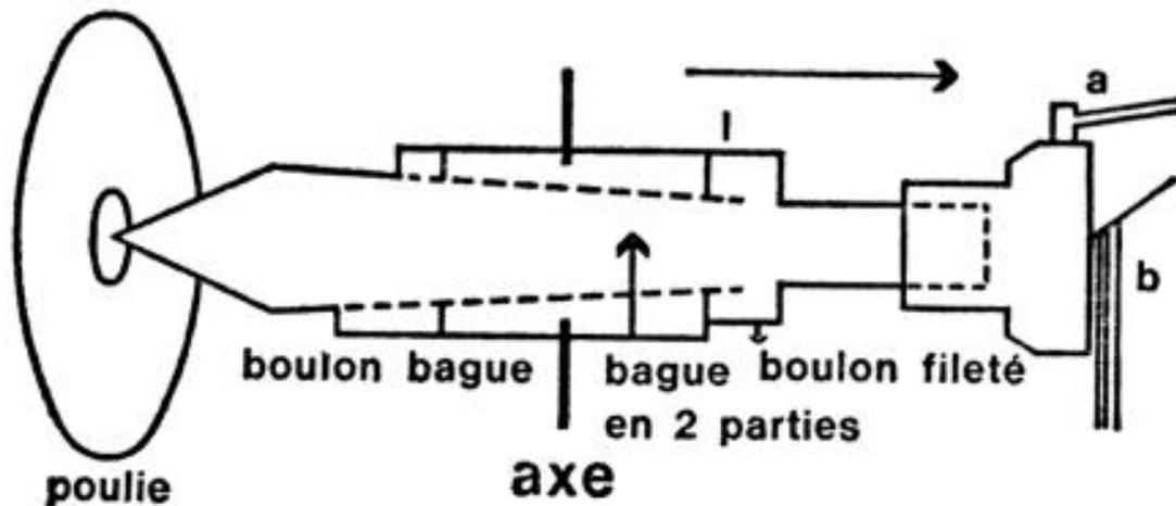
La fraise se déporte dans le sens indiqué par la flèche ; étant montée sur un cône, il en résulte que la rainure non seulement cesse d'être au milieu, mais encore est de moins en moins profonde, ou même cesse de se produire.
